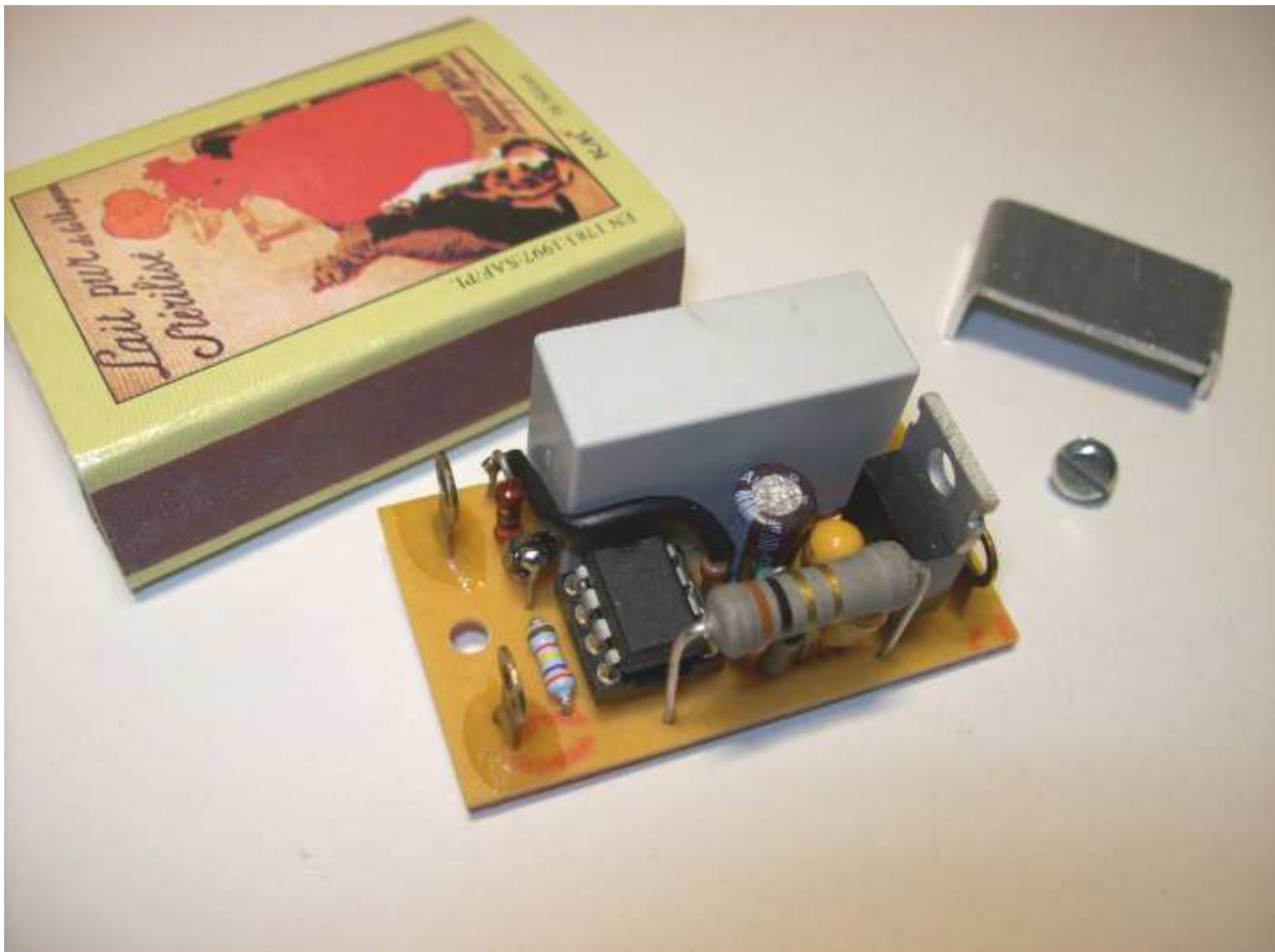
Abbildung 22: Platine mit abgeschraubter Triac-Kühlflasche
